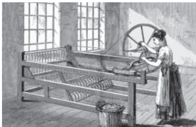
Машину за предење „Џени“ створио је Енглец Џејмс Харгривс
